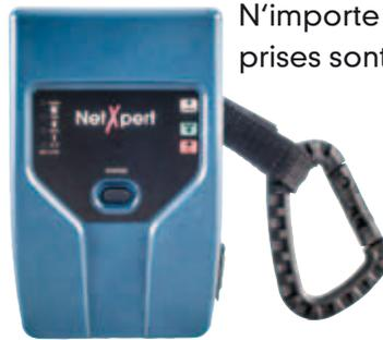
N'importe quelle catégorie de câbles, panneaux ou prises sont installés, le NetXpert permet de certifier, si le câblage est capable de transmettre des données à des débits jusqu'au Gigabit Ethernet. Le NetXpert 1400 effectue des tests avec des données réelles et des tests de taux d'erreurs de bit (BERT) basés sur la norme IEEE 802.3ab pour vérifier si 100 Mbit/s ou 1 Gbit/s sont transmis sans erreurs. En plus, les paramètres
